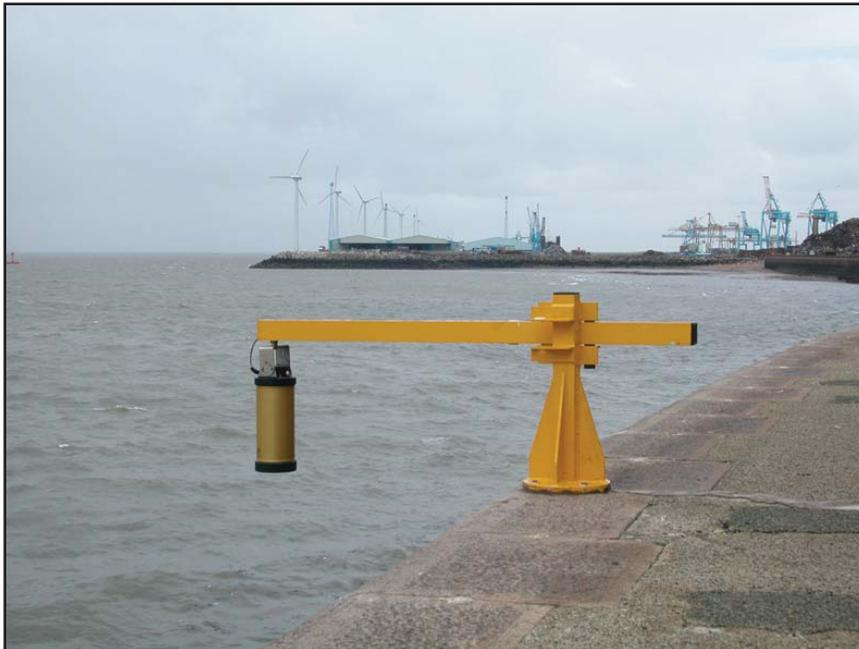
**Figura 3-20b.** Instalación de prueba de mareógrafo de radar Kalesto OTT en Liverpool, Inglaterra.
