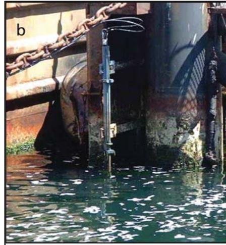
**Figura 3-18b.** Medidor de presión fijado a un muelle en Puerto Stanley.
